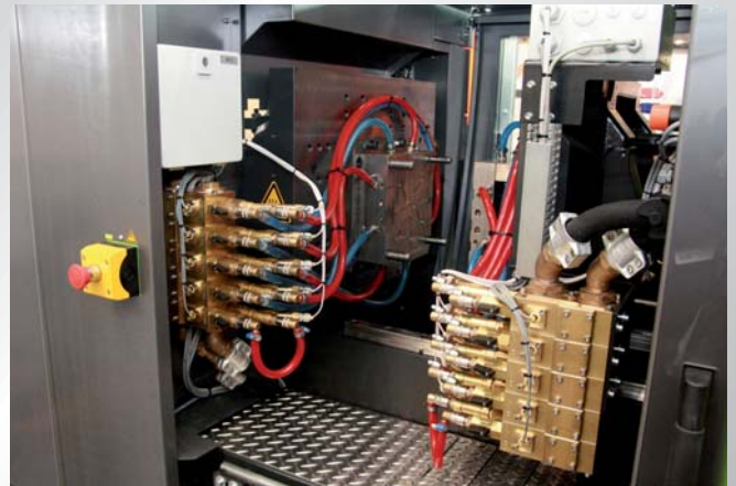
RHYTEMPER® FlowWatch, hier 10 Kreise in Werkzeugnähe integriert RHYTEMPER® FlowWatch, 10 circuits integrated near the moulds
