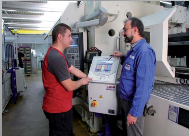
RHYTEMPER® FlexControl Zentrale Bedieneinheit für den Einsatz an größten Werkzeugen mit bis zu 128 Regelkreisen. RHYTEMPER® FlexControl central operator panel for use with the largest moulds up to 128 control circuits.
